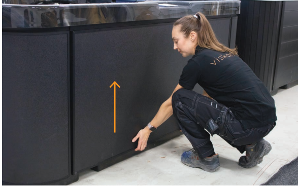
1. Työnnä paneelia ylöspäin, kunnes paneelin takapuolen urat vapautuvat alhaalla olevista hahloista
