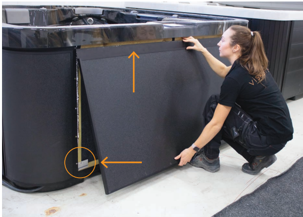
1. Paina paneelia ylöspäin niin, että yläreuna menee hahlojen väliin. Paina paneelia eteenpäin ja laske paneelia niin, että paneelin takapuolen urat lukittuvat alahahloihin.
